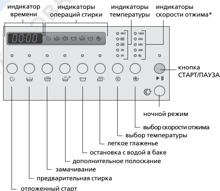
Рисунок 3 – Зоны индикации и кнопки управления http://rembitteh.ru/
